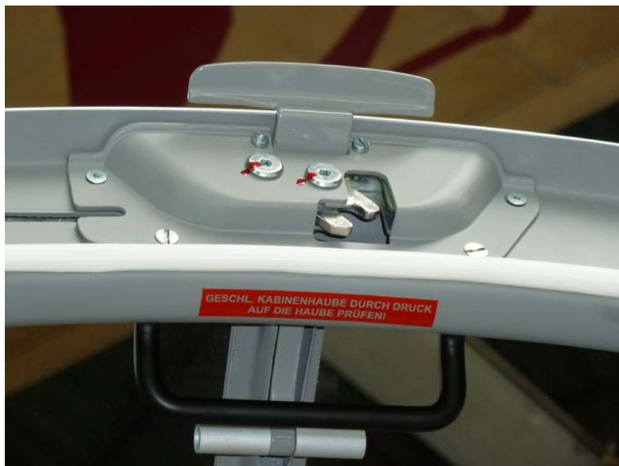
Obr.1 – Zámek namontovaný v krytu kabiny (v odjištěné poloze)
